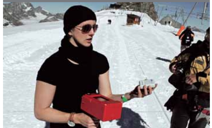
Demonstration von «Smilla», dem Prototyp von Lambda:4. Rechts ein Sender, links das Ortungsgerät.
