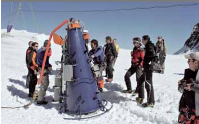
Erklärungen rund um die spektakulärste Innovation: Mit DaisyBell können auf eine neue Art Lawinen ausgelöst werden.
