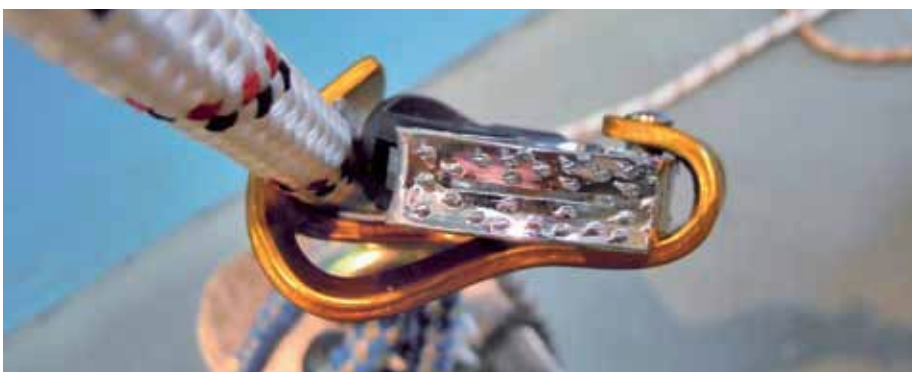
Das Risiko illegaler Petzl-Kopien im Bild: Karabiner und Seilklemme gingen bei geringer Last kaputt. Fotos: zvg.
