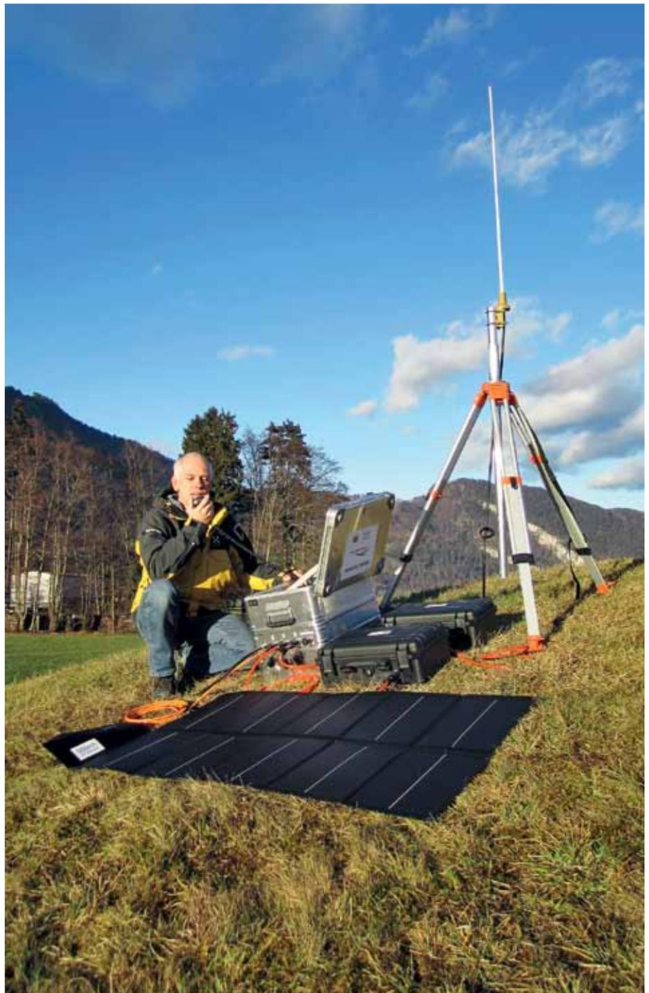
Montiert und betriebsbereit: der Alukoffer mit Empfangs- und Sendegerät, die Antenne, zwei Koffer mit Blei-Gel-Akkus und das Solarpanel. Foto: zvg
