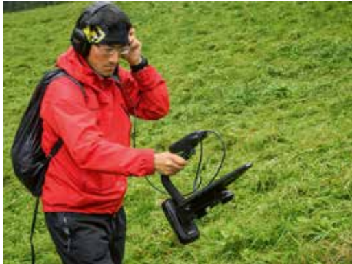
Das Detektionsgerät NeoSoft SAR kann Handys orten.
